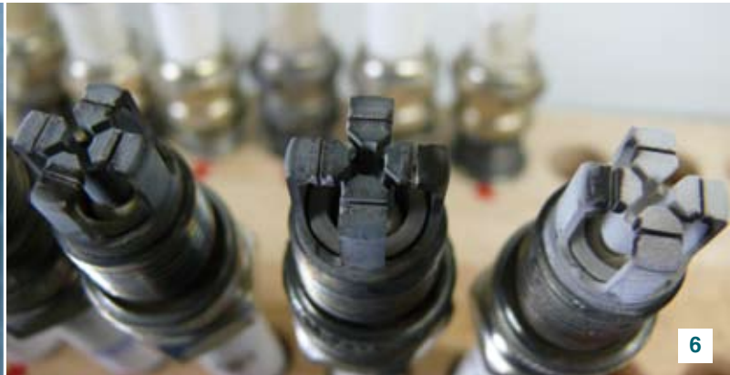
1. MAN E 2842 LE 302 V12 Kolben mit Ringnuten; 2. MAN E 2842 LE 302 V12 Lagerschalen; 3. MWM TCG 2016 V12 Kolben mit Ringnuten; 4. MWM TCG 2016 V12 Ventiltrieb; 5. GE Jenbacher J 312 V12 Kolben mit Ringnuten; 6. GE Jenbacher J 312 V12 Zündkerzen; 7. MTU Onsite Energy AB 3066 L4 V6 Ventiltrieb; 8. MTU Onsite Energy AB 3066 L4 V6 Aus- und Einlassventil.
